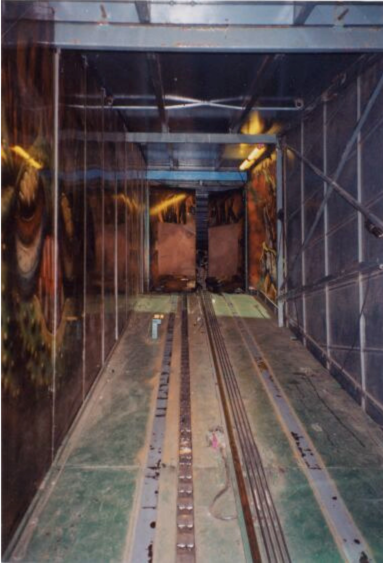
Schienenführungssystem in K.W. Fellerhoffs "Godzilla's Monster".
