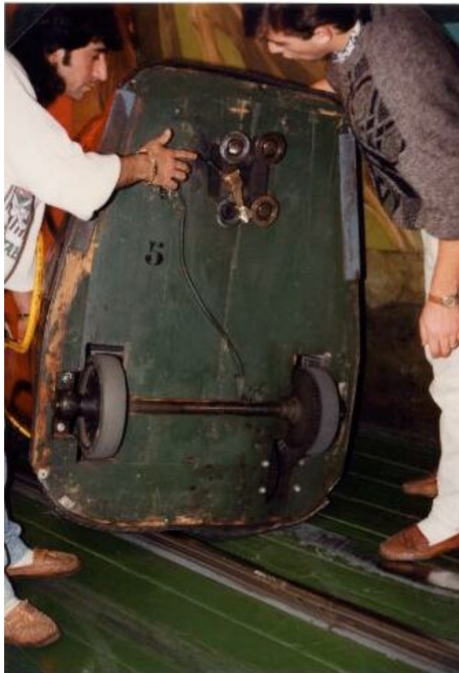
Die Wagen haben Holzböden. Rollenführungskörper mit Kugellagern.
